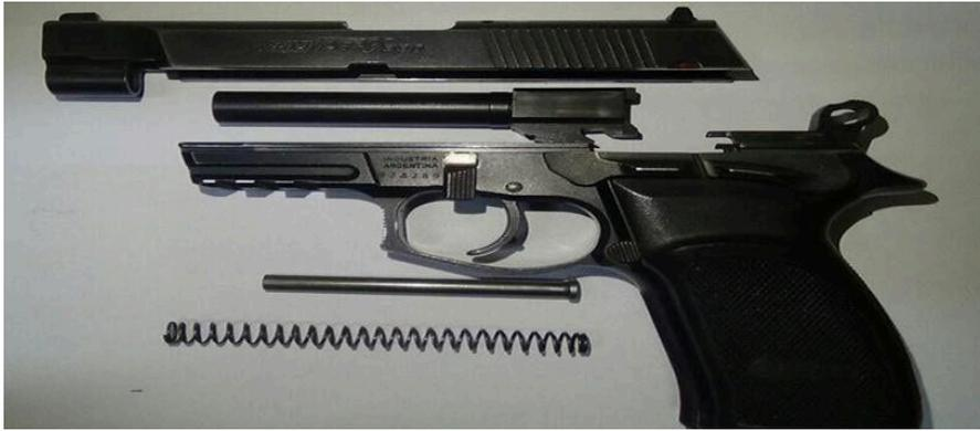
La doble acción permite como en el caso del revólver transportar el arma cargada con cartucho en recámara y el martillo desmontado, y efectuar el disparo simplemente presionando la cola del disparador.
